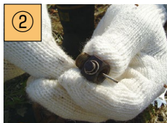
②ノズル内の詰まりを針金等で貫通させる。
